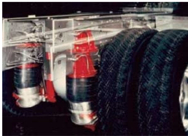
Figura 6 - Suspensão a ar em caminhão
