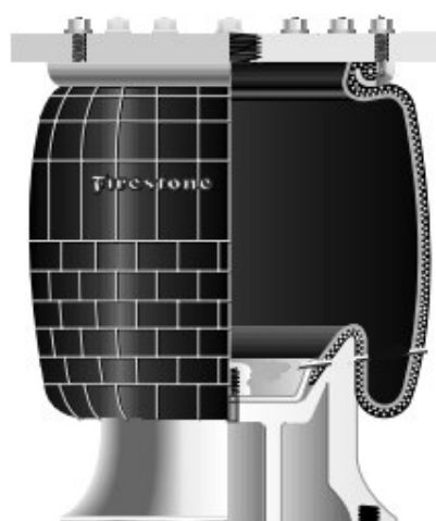
Figura 9 - Mola pneumática de manga reversível
